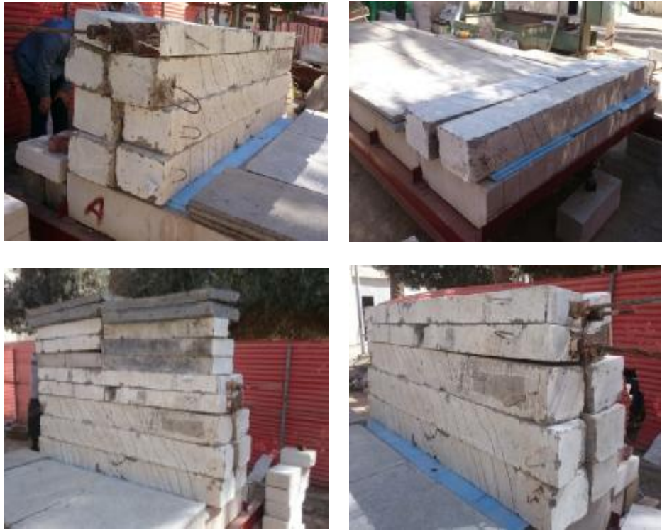
شكل رقم (11) تحميل خانة واحدة بالوضع العمودي للترمستون
