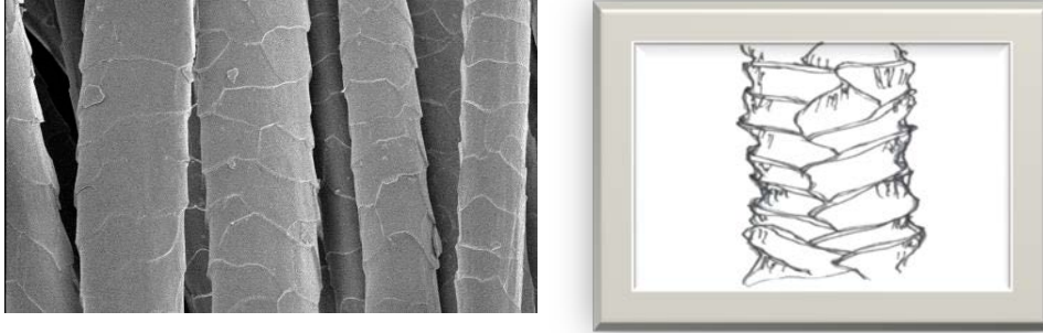
الشكل ( 1 ) صورته مكبرة ليف من الصوف بواسطة المجهر الالكتروني الماسح وتظهر الحراشف على سطح الليف (10)
