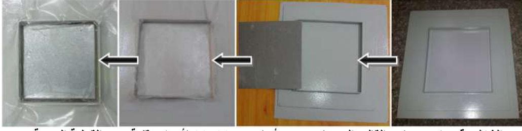
الشكل رقم (1) : يوضح القالب المستخدم وهو بأبعاد 20x20 cm لأجراء تقنية صب القوالب اليدوية .
