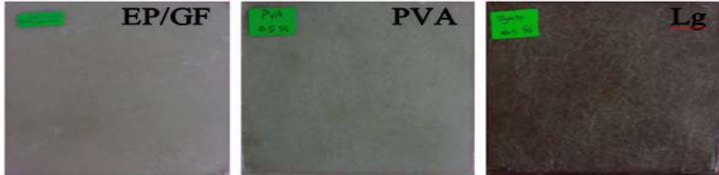
الشكل رقم (2) : يوضح مقولبات المواد البوليمرية المترابطة بعد اجراء عملية الصب اليدوي والمعالجة
