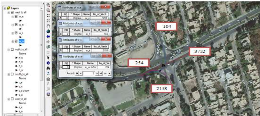
الشكل (9) التيارات المرورية المتفرعة من ذراع التقاطع الغربي في تقاطع جامعة بغداد المصدر: اعداد الباحثين بالاعتماد على الصورة الفضائية بالشكل (7) والتيارات المرورية بالجدول (1)
