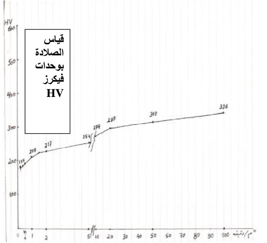
شكل (A-1) مقطع مخطط العلاقة بين الصلابة ومعدل سرعة التبريد للفولاذ (25Cr Mo4) ضمن مدى فحص جهاز التمدد
