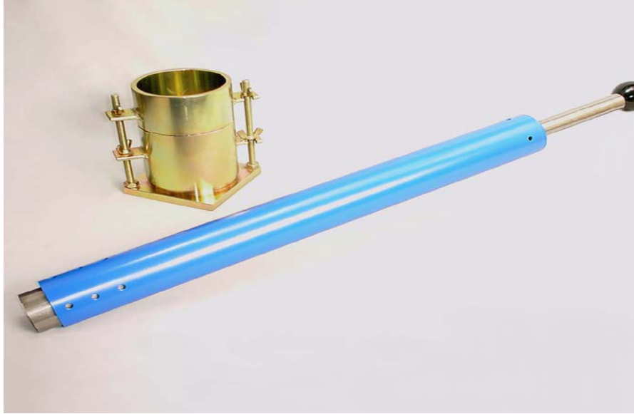
الشكل (2): القالب القياسي لرص التربة مختبريا.
