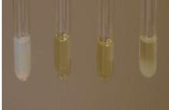
شكل رقم (2) قياس كمية الماء المفصولة من المستحلب المحضر بمرور الزمن.
