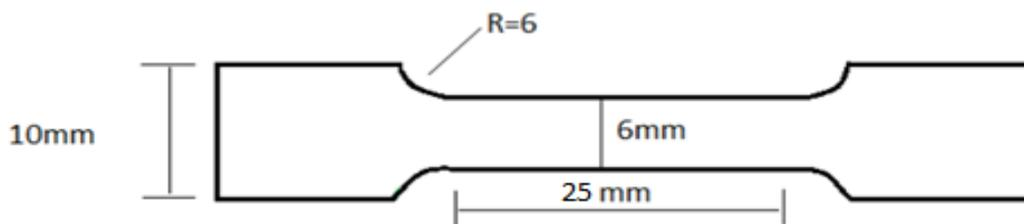
**Figure 3: Tensile specimen**
